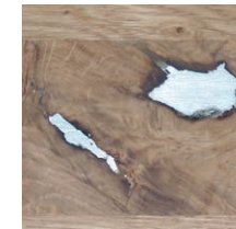
Mit Zinn ausgegossene Astlöcher und Risse.
